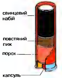
Патрон мисливський У сучасних мисливських набоїв свинцева куля міститься у пластиковому корпусі
